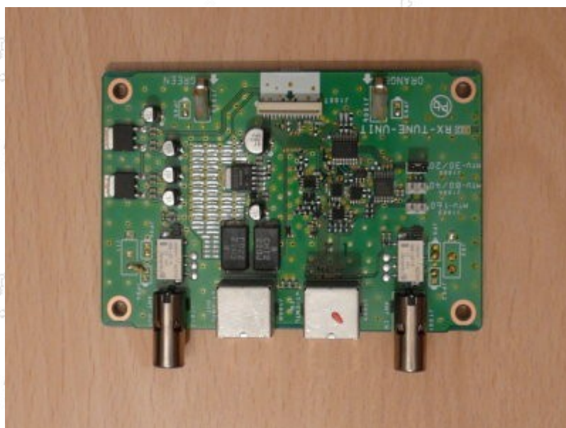
Die RX-Tune Einheit mit gestecktem 30m/20m Jumper (oben rechts).
