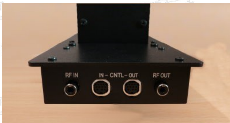
Fertig montiertes \mu -Tune Filter. (Ansicht auf die Anschlüsse.)
