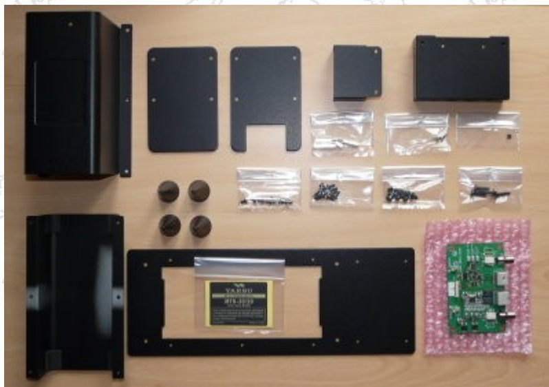
Gehäuseteile mit Aufkleber und Steuerungseinheit (RX-Tune Unit).
